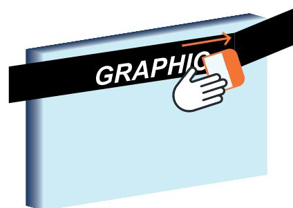
Applica lo strato adesivo aiutandoti con una spatola per evitare la formazione di bolle d'aria e garantire l'applicazione ottimale
